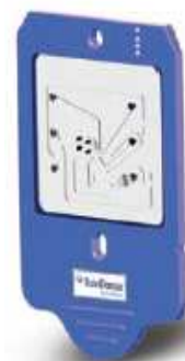
Рис. 11. Одноразовый нанофлюидный чип для генерации эмульсии для ПЦР
